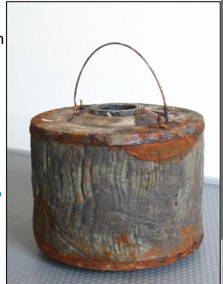
Stark verschmutztes und verschlammtes Filterelement
